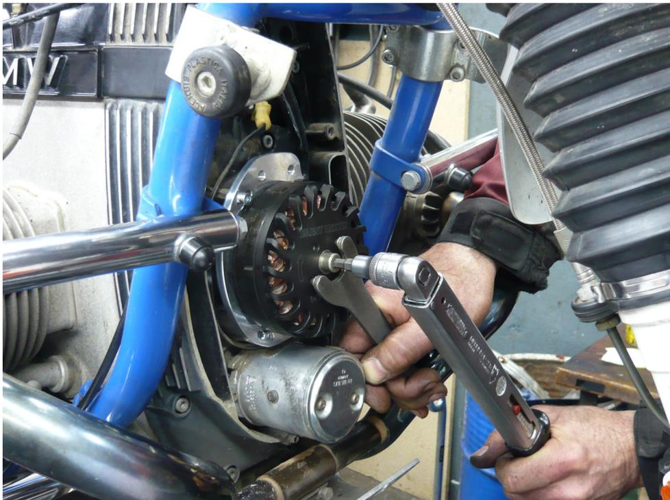
Grundeinstellung des LiMa-Rotors für die PowerBlock Zündung:
