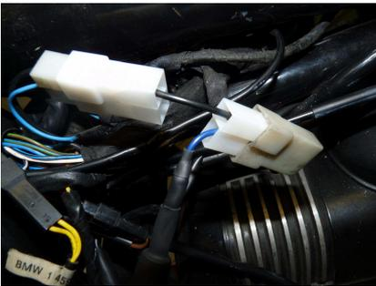
3. Das freie Ende des WKS schliessen Sie an der Zündspule (Klemme 15) zusammen mit dem dort abgehenden grün-schwarzen Kabel an.
